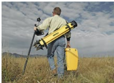
Levantamentos topográficos: no modo Robótico, uma só pessoa pode medir e registar pontos tão rápido quanto possa caminhar.
